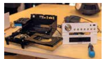
Fehlerdiagnose an demontiertem CD-Laufwerk
