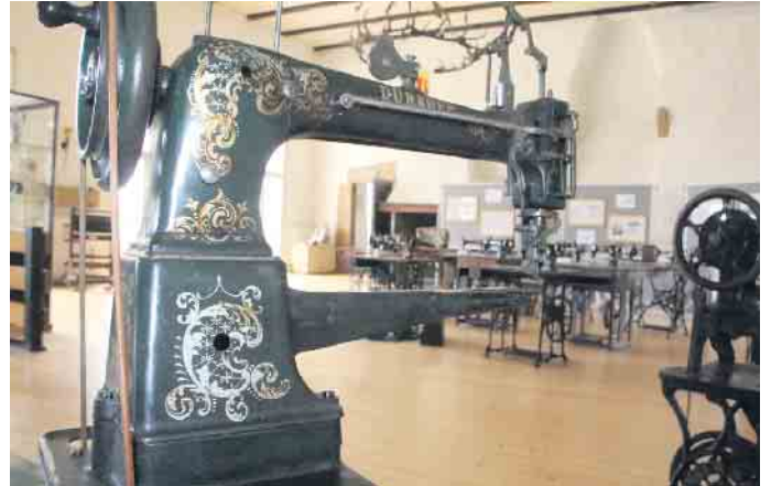
Diese Schuster-Nähmaschine der Firma Dürkopp von 1931 durchsticht auf zähestes Leder.
