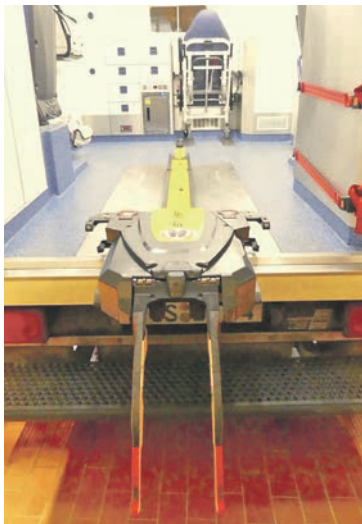
Auf diese Hebevorrichtung wird die moderne Rettungstrage „Stryker“ geschoben und mittels hydraulischer Kraft wird die Trage angehoben und das scherenartige Untergestell mit den vier Rollen eingefahren.
