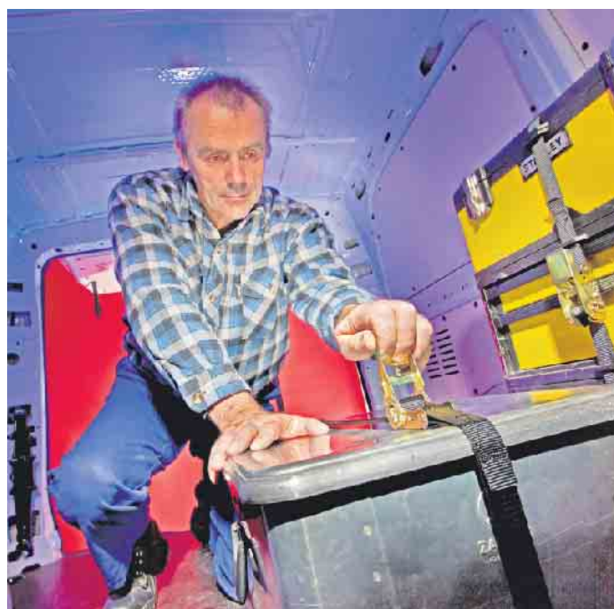
Fest verzurret: Vor Fahrtantritt muss der Fahrzeugführer die Ladungssicherung kontrollieren. Dabei ist es egal, ob es sich um Baustellen- Utensilien oder das Urlaubsgepäck handelt.
