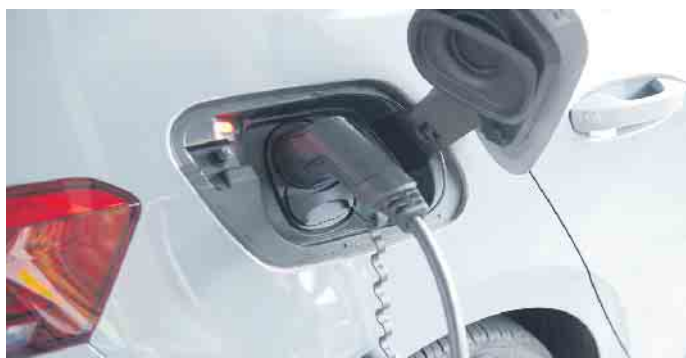
Das bidirektionale Laden befindet sich aktuell in der Testphase. Besondere Vorteile bestehen in Verbindung mit einer Photovoltaikanlage. Foto: DJD/E.ON/Malte Braun
