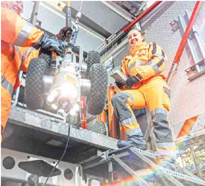
Hightech im Kanal: Ferngesteuerte Kameraroboter liefern scharfe Bilder, die anschließend mit KI-Unterstützung ausgewertet werden. Foto: DJD/VDRK/Sascha Kreklau
