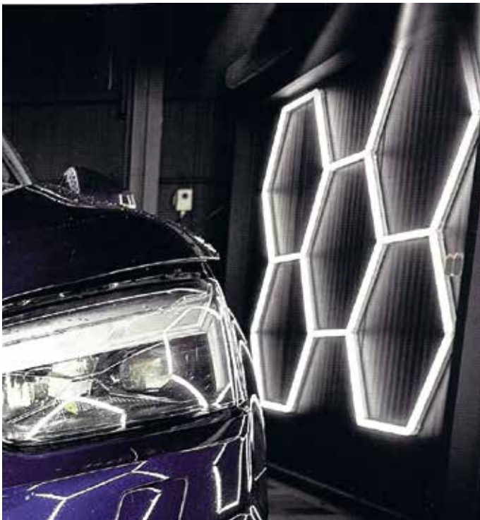
Wabenleuchten in der Annahme-Halle: So entdeckt man alle Schäden.
