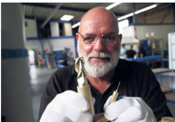
Diese bei b-TEC beschichteten Fräser halten 200mal länger, als die unbeschichteten Werkzeuge.
