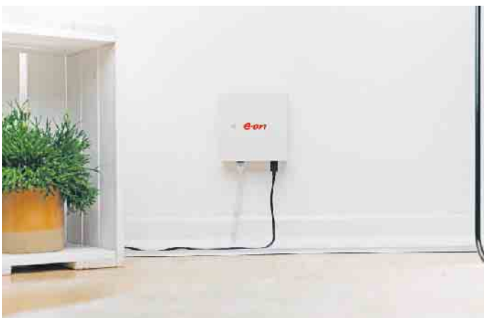
Die kompakte Box dient als Steuerzentrale und verknüpft bestehende Energielösungen wie Photovoltaik, Batteriespeicher oder Wärmepumpe zu einem effizienten System. Foto: DJD/E.ON/Max Kruse
