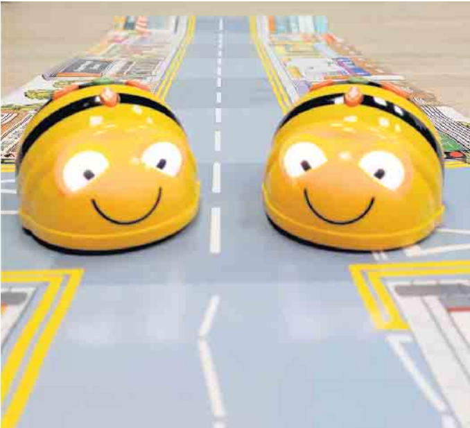
Der Bee-Bot ist ein Bodenroboter in Gestalt einer Biene.
