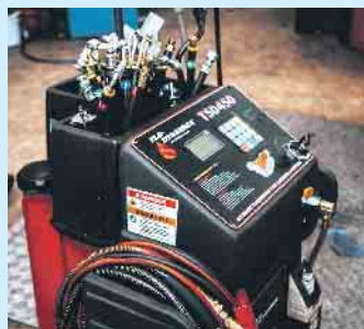
Automatikspülung mit Gerät von Flo-Dynamics
