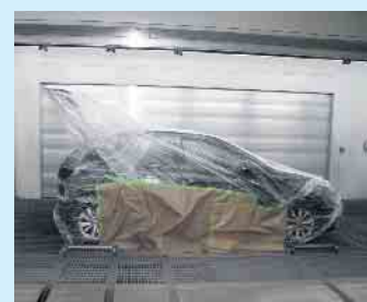
Auf Wagen montiert und seitwärts in die Lackierkabine geschoben
